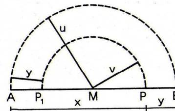
Traslando o ribaltando l'incognita  $y$  di  $180^\circ$  gradi sul medesimo segmento  $AB$  facendo centro con un compasso nel punto di mezzo « $M$ », si formano così due semicerchi<sup>(3)</sup> di diametro rispettivamente pari a  $2u = x + y$  e  $2v = x - y$ , ovvero « $v$ » è la semidifferenza tra i segmenti  $AP$  e  $AP_1$ ; quindi  $v = (x - y) : 2$ .
